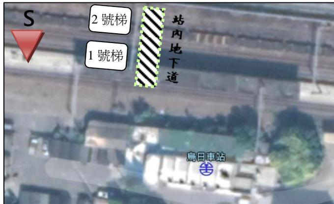
依原設計構想施作本案工程之電梯開挖基地約需 3.5 公尺寬、6 公尺長的範圍，由地面向下開挖約為 7 公尺以施作機坑及昇降道結構牆體，配合垂直深開挖需設置擋土設施，因站房側工區（後稱「1 號梯」）上方無架設電車線且距鄰近電車線大於 6 公尺，整體施工空間較為餘裕，可以使用大型機具打設鋼軌樁（如振動式樁錘挖土機）及施作深開挖（如長臂挖土機），並使用大型吊車吊掛 H 型鋼作為深開挖擋土圍苳；然而因月台寬度僅約 5.20 公尺（如圖 9），月台側工區（後稱「2 號梯」）可作業空間較為狹窄，另月台處上方為混凝土雨棚、兩側則為帶電之台中線東西正線每日運行中，月台開挖無法進駐大型機具開挖（如 12 噸以上挖土機），且考量為維持月台兩側 1.5 公尺人行通道寬度（如圖 9、10），僅能以採用人工持電動機具或小噸數挖土機施作開挖方式為主，可施作範圍則限於使用地下道樓梯部分開挖施作昇降道（含扶手牆面共約 2.2 公尺寬）。
