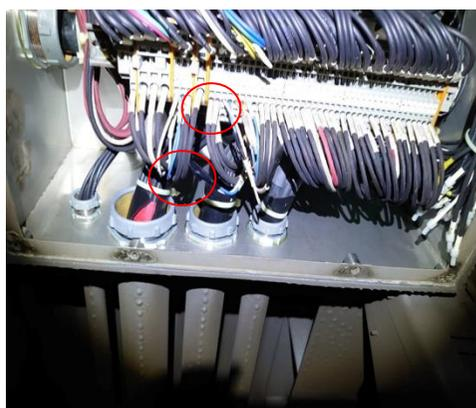
圖 2 可了解到 PP 自強號 74 芯接線盒箱蓋所在位置，車下前後部各有一只，分別連接到各自的 74 芯線，這邊就可看到固定螺絲處，僅以外六角螺絲固定，若以加班車的使用頻繁度來看，長時間勢必會造成螺紋的損傷，嚴重則還會滑牙或崩牙。
