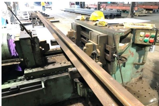
照片 15、軌彎軌作業
