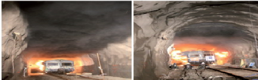
圖 1 隧道列車火災全尺度實驗情形 【3-9】
