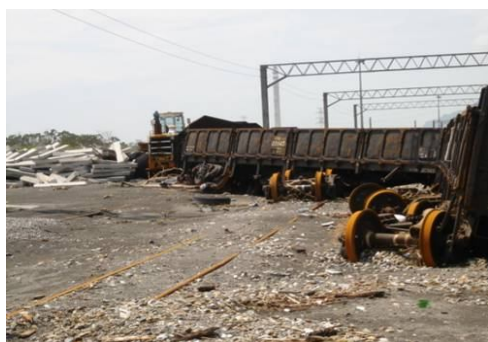
圖 22 泰利颱風引發大浪打翻漢本站內貨車 圖 23 泰利颱風大浪沖散存置之彈性軌枕
