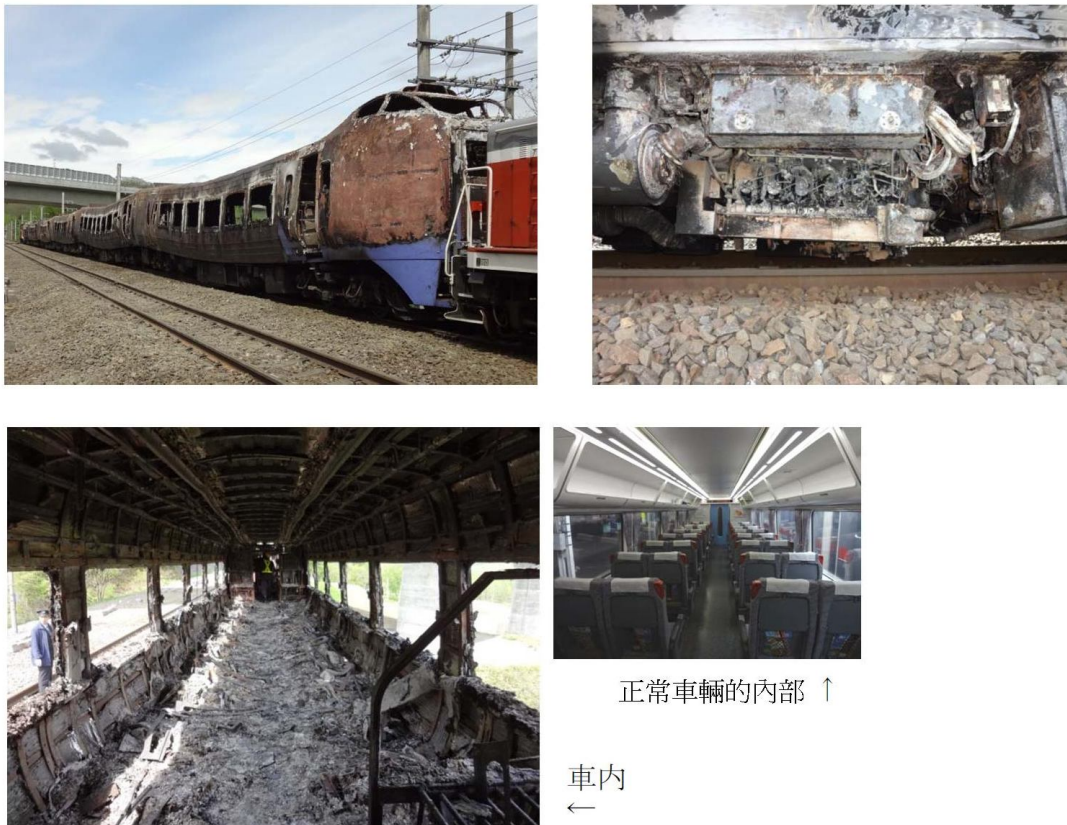
圖 12 火災後列車受損情形 [15]
