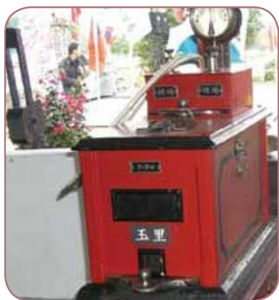
民國 69 年北迴鐵路啟用人工閉塞電氣路牌方式行車，稱為人工號誌。圖為電氣路牌閉塞器
