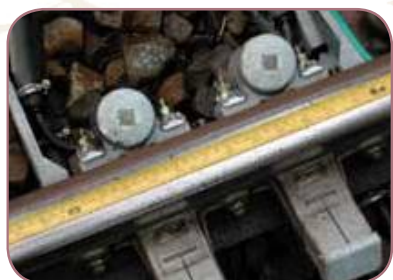
計軸器計軸頭，應用雙重化降低號誌故障影響行車的風險。
