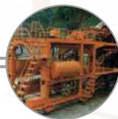
隧道工程： 引進隧道門型鑽堡機
