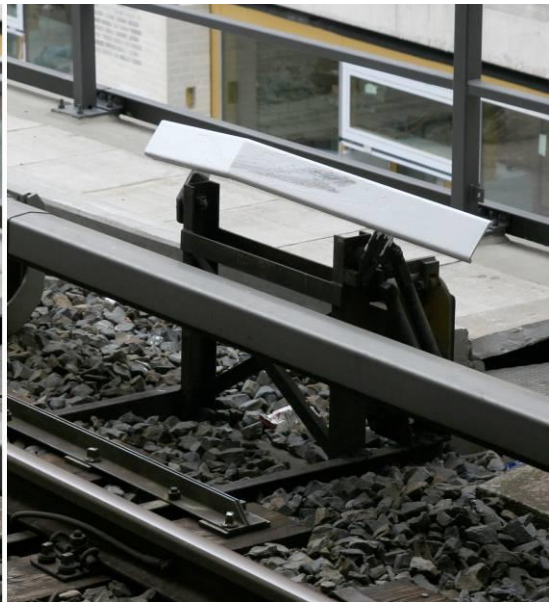
(b) 號誌顯示「平安」時絆腳器的位置
