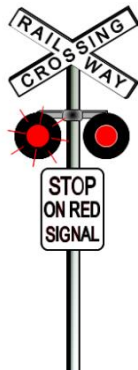
[A] 設有主動防護設備（僅警報裝置）
