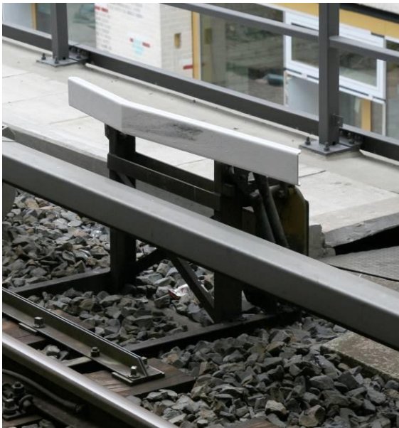
(a) 號誌顯示「險阻」時絆腳器的位置
