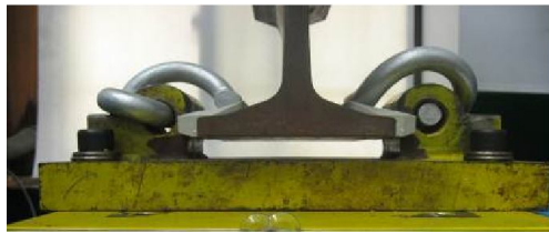
圖 4 軌道扣夾扣壓力測試圖
