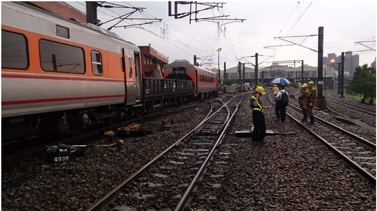
調車前進方向第 2 車 PPH1339 行走雙線發生 2 軸出軌
