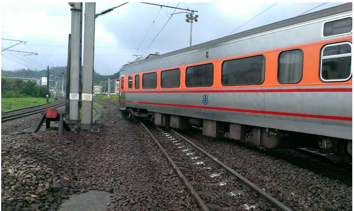
調車前進方向第 2 車 PPH1339 行走雙線發生 2 軸出軌
