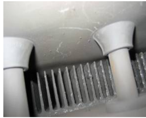
圖 3 散熱片式模組
