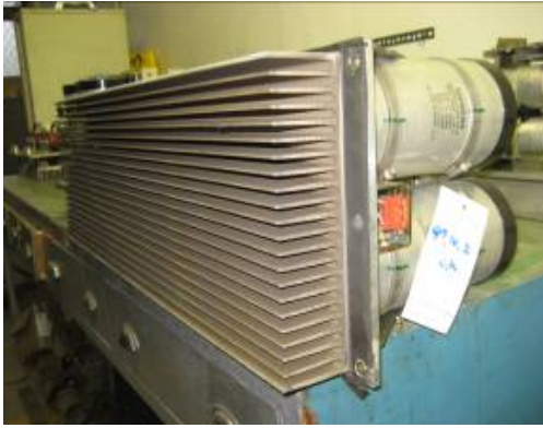
圖 2 安置在牽引轉換器中間之模組的散熱翼片
