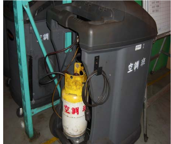
空調機灌冷煤機
