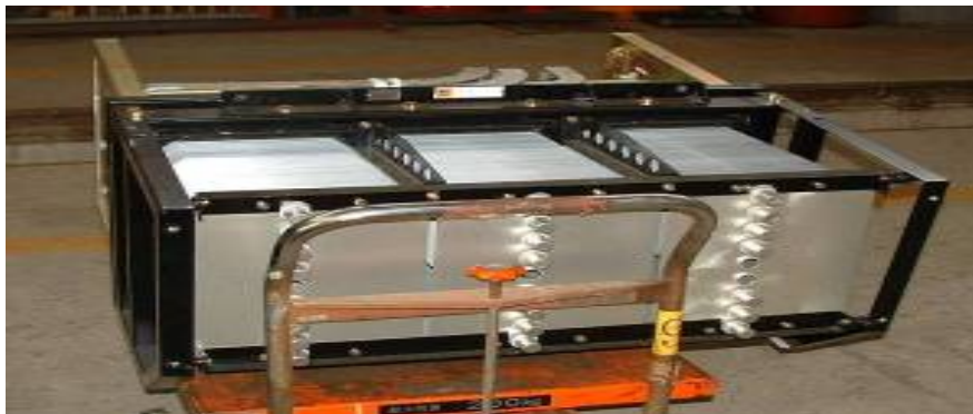
圖 6 熱管式模組之熱管及固定散熱片
