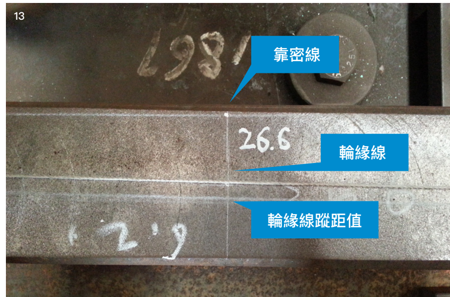
圖 13： 依靠密線與輪緣線位置確認 輪緣線蹤距值與圖面標示是 否相符 靠密線與輪緣線定位
