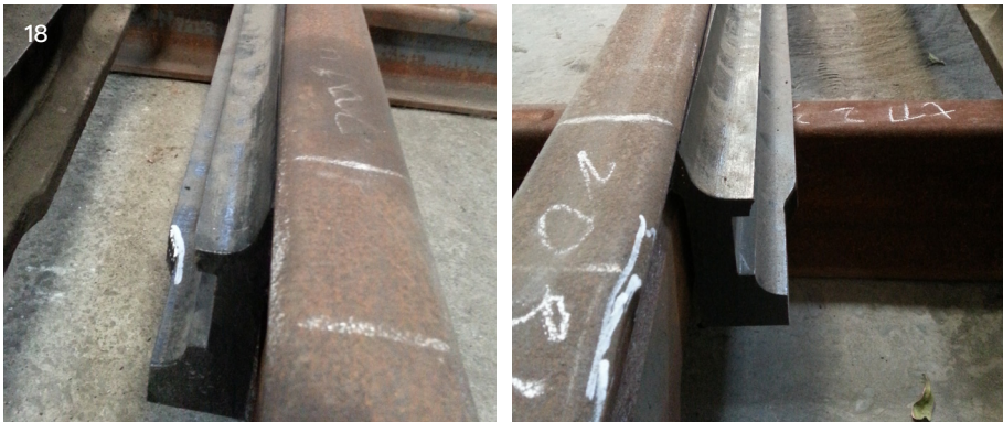
圖 18：確認兩支尖軌貼合的密合度情況良好 密合度確認
