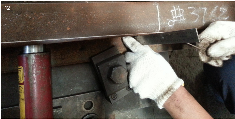
圖 12： 於曲折點劃記線固定點拉直 綿繩確認彎軌後尺寸 曲折點劃記線固定點
