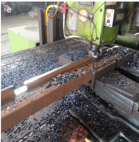
圖 8： 進行底部加工時需保留部分 長度面積，以供刨床加工時 工件夾持使用 軌底銑削作業
