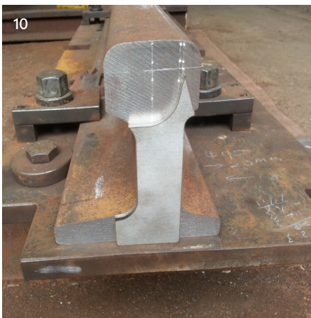
圖 10： 將檢規置於鋼軌斷面即可快 速且正確的將斷面加工外形 標示於鋼軌上 以檢規劃記端面
