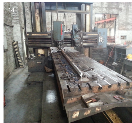
圖 14： 尺寸標示無誤後即可將鋼軌 固定於刨床機臺上 靠密線刨削作業
