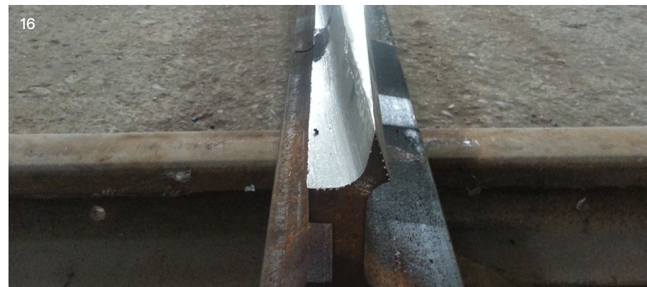
圖 16： 完成 11m 尖軌的輪緣線及靠 密線加工 輪緣線及靠密線加工完成
