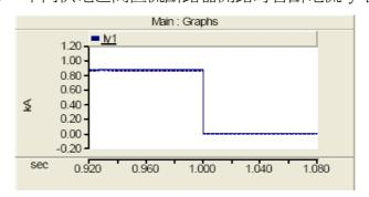
圖35 不同供電區間直流斷路器閉路時啓斷電流Iv1圖
