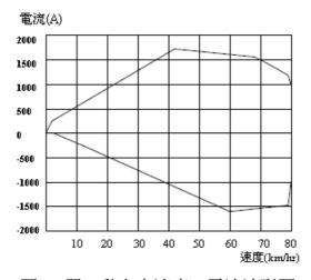
圖36 單一動力車速度—電流波形圖
