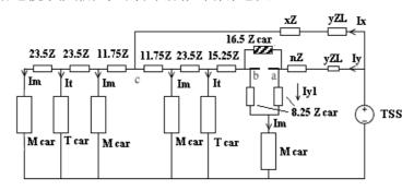
圖24 橫渡線導電軌間隙電路圖
