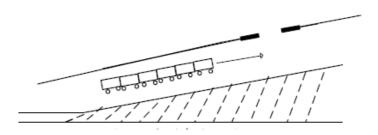
圖38 電聯車向上坡行駛之導電軌間隙
