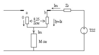
圖16 集電靴在b點脫離導電軌
