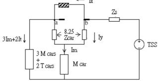
圖18 馬達車在橋接狀況下,第二集電靴脫離導電軌
