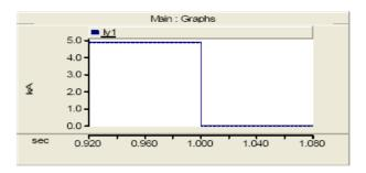
圖34 不同供電區間直流斷路器開路時啓斷電流Iy1圖
