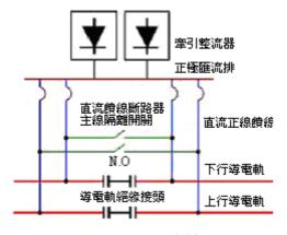
圖9 IRJ組件設置絕緣接頭
