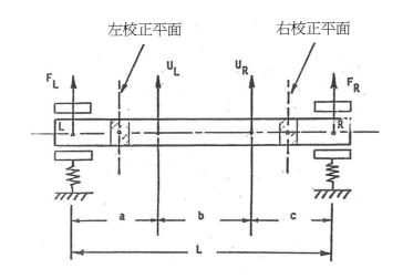
圖 8 轉子上的不平衡力,校正平面,與軸承傳送力[1]
