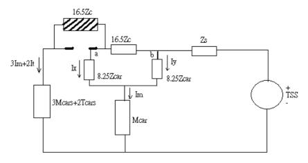
圖17 馬達車在橋接狀況下,第一集電靴脫離導電軌
