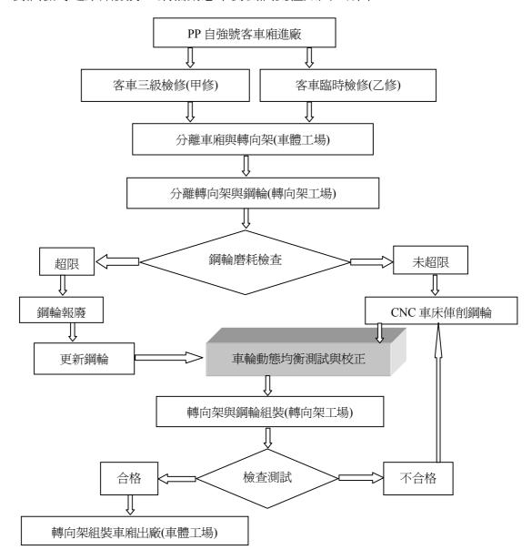
圖 5 鋼輪動態平衡測試相關配合工程圖
