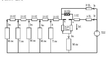
圖19 TSS饋線間之導電軌間隙電路圖
