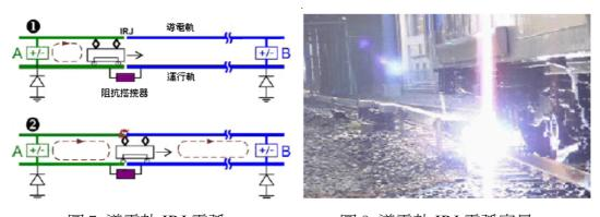
圖7導電軌IRJ電弧
