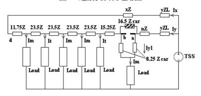
圖29 袋狀導電軌間隙電路圖
