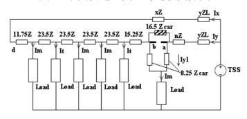
圖33 袋狀導電軌間隙電路圖
