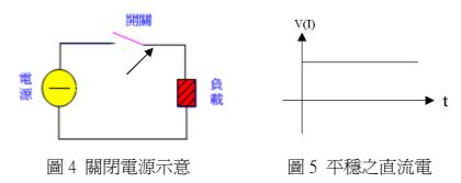
電流途徑於任何時間被中斷時,在中斷的金屬間隙間引起的電弧,會在任何時間內產生,無法避免。
