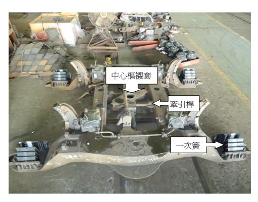
圖 9 轉向架相關零組件材料位置圖
