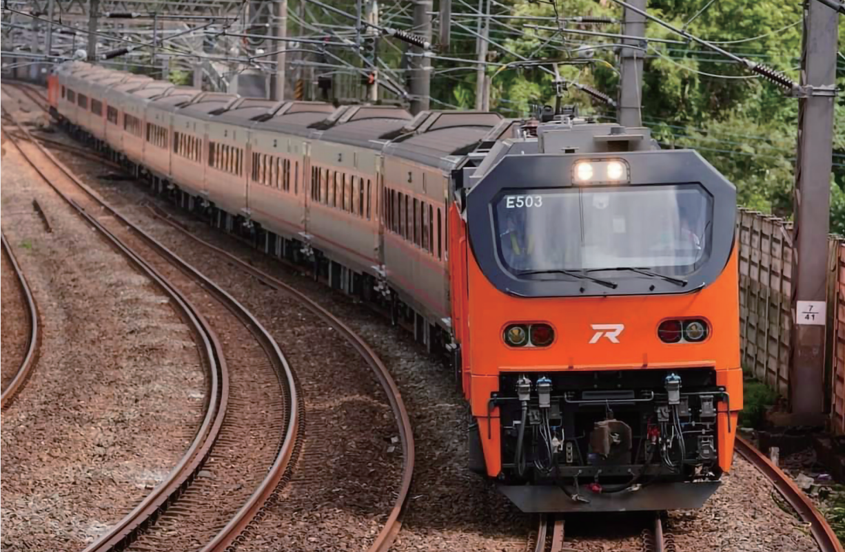
新型車輛環保節能設計，具有再生電軔，可將電力回饋電車線供其他閉塞區間內的車輛使用，有效節電
