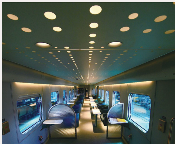
山嵐號 X 海風號——車廂中頂板燈光以點狀設計，其中加裝崁燈，提供桌面照明
