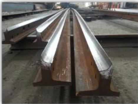
圖 12 輪緣線及靠密線鉋製完成
