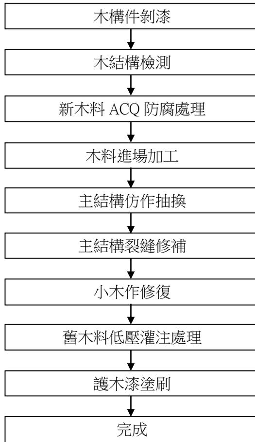
圖 3-1 木結構修復施工流程圖
