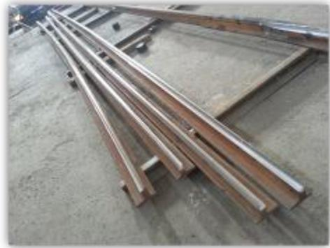
圖 13 輪緣線及靠密線鉋製完成
