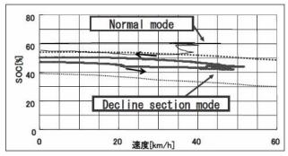
圖 7 運行測試時之蓄電池蓄電量(SOC)軌跡<sup>[3-9]</sup>
