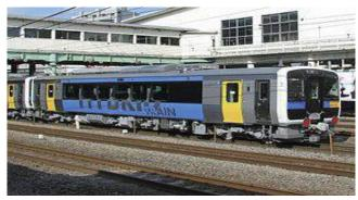
圖 1 Ki-Ha E200 型油電混合動力車輛[3-9]
