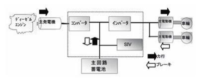
圖 2 Ki-Ha E200 型 油電混合系統<sup>[3-9]</sup> 表 1 主回路系統規格<sup>[3-9]</sup>
