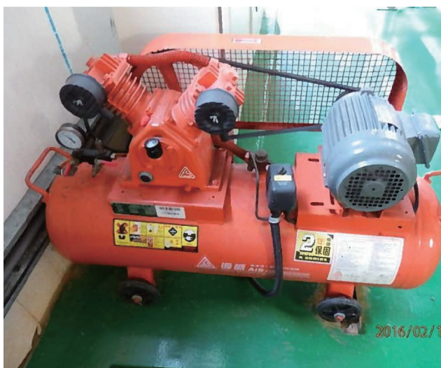
圖 12 空壓機提供所需壓力
