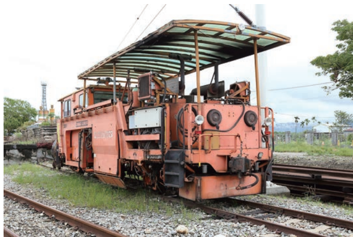
維護火車行駛安全的巡檢車。
