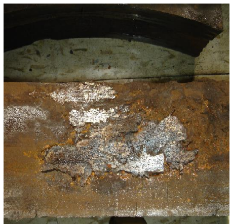
圖 4 合成閘瓦的金屬鑲嵌(積鐵)
