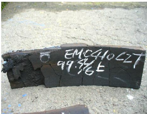
圖 5 發生三熱現象之閘瓦
