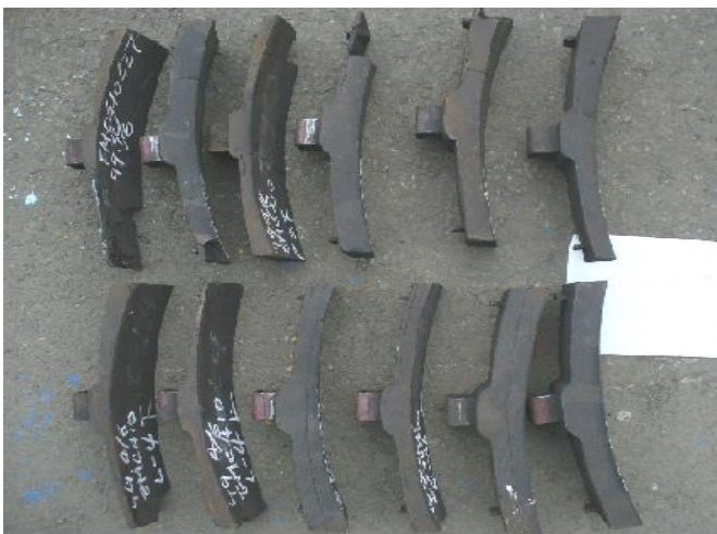
圖 7 閘瓦耐磨性不穩定
