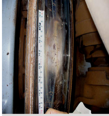
圖 9 車輪滑走致熱損傷剝離
