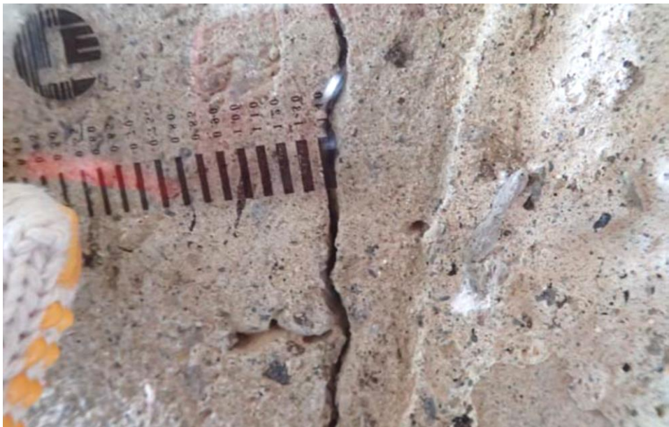
圖 6 以裂縫尺量測裂縫寬度
