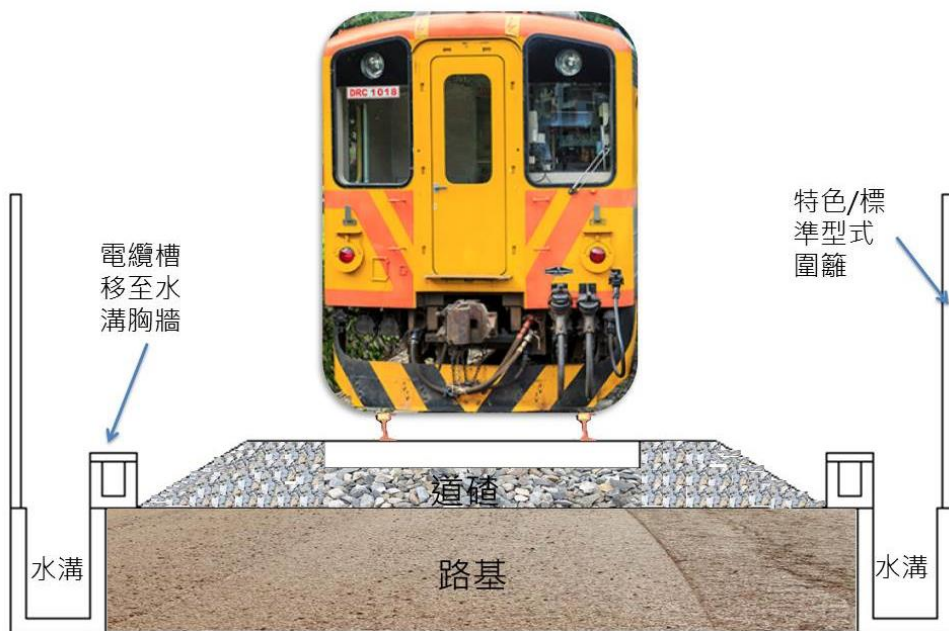
圖15.水溝、圍籬及電纜槽共構斷面示意圖
