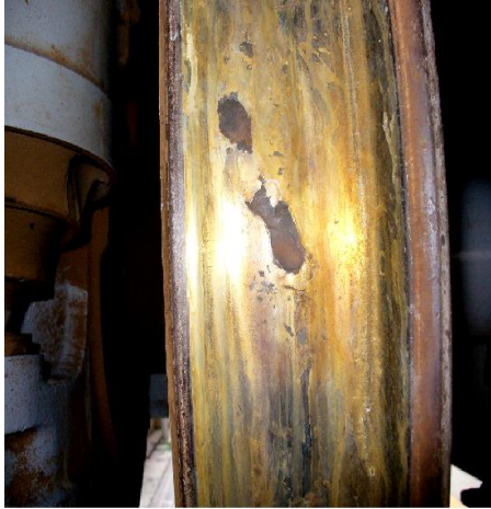
圖 8 熱損傷致踏面剝離崩裂
