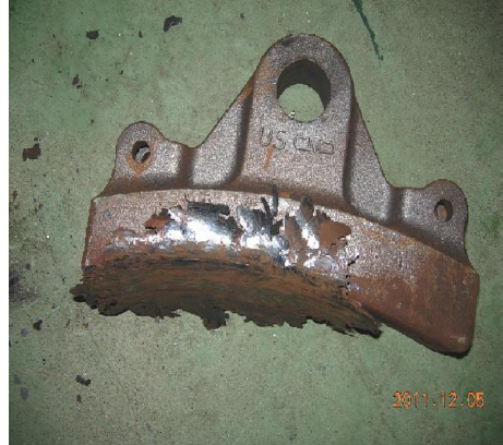
圖 2 鑄鐵閘瓦的金屬鑲嵌(積鐵)
