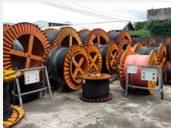
露天存料分區堆置並豎立標示牌 (2)
