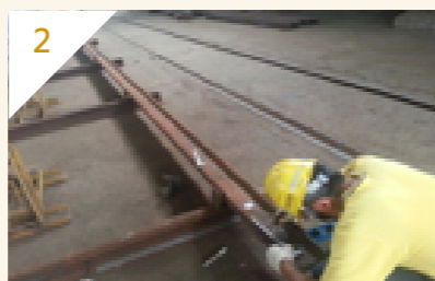
尺寸劃記 註：依圖面標示尺寸，以游標卡尺及石筆於鋼軌表面劃記
