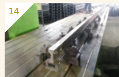
踏面銑削作業 註：完成踏面銑削作業
