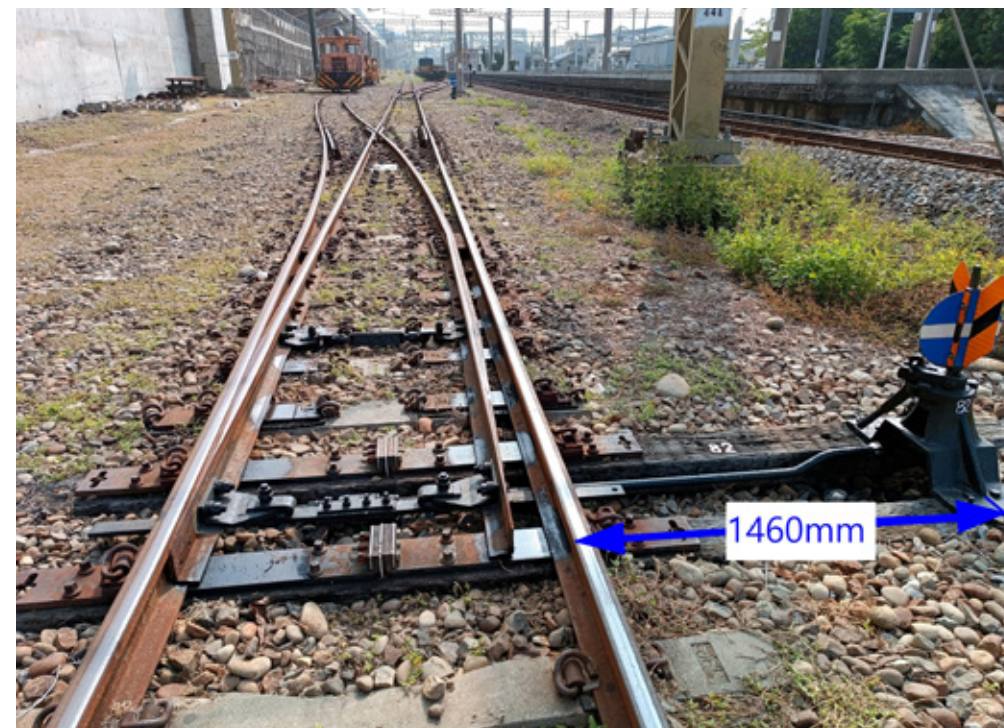
照片② 小型標誌型轉轍器 小型標誌型轉轍器距離軌距線 1460mm
