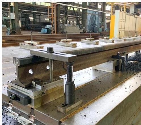
在彎軌機方面，鋼軌彎曲製程是利用 3 點定弧原理，於鋼軌腹部施加壓力，當施加壓力超過鋼軌降伏強度時，即可使鋼軌永久變形成我們需要的曲線，因此，為了有效將油壓施加的力量傳遞到鋼軌上，需將治具外型設計為鋼軌軌腹斷面的形狀（如照片 10），而 UIC60 尖軌屬於新的斷面，需重新設計軌腹模具，藉由這次的設計，我們將原本需整組重達 1kg 的模具，改變其安裝方式，以快拆設計重新製造（如照片 11），使更換模具重量減少至 300g，更換時間亦縮短至原來的 1/10（如照片 12 及照片 13）。
