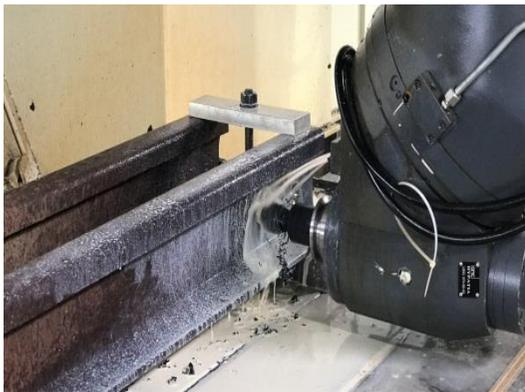
照片23 CNC 基本軌靠密線平面加工
