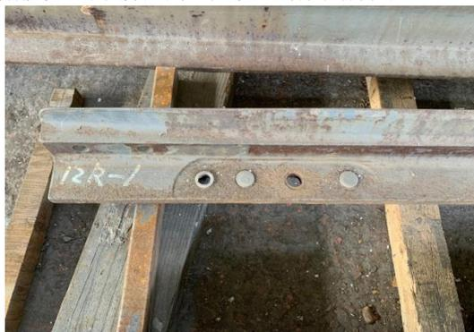
照片 7 新製尖軌螺栓孔位置加工
