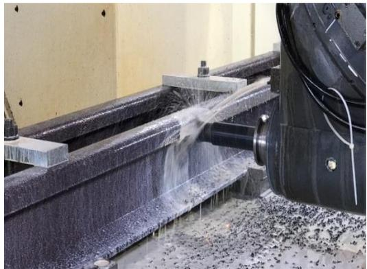
照片24 CNC 基本軌最佳化曲線加工
