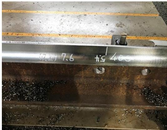
圖19 檢規檢測斷面尺寸
