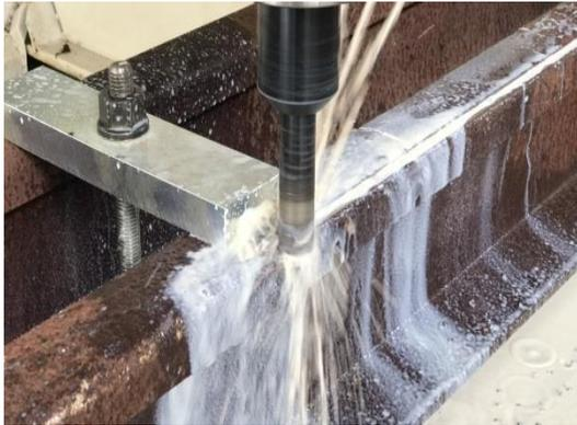
照片25 CNC 尖軌輪緣線加工
