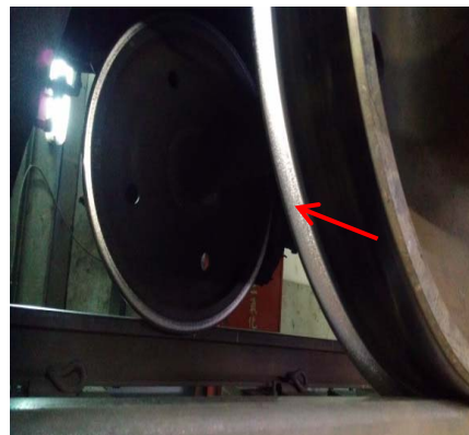
圖 5 DRC 輪緣異常直立磨耗
