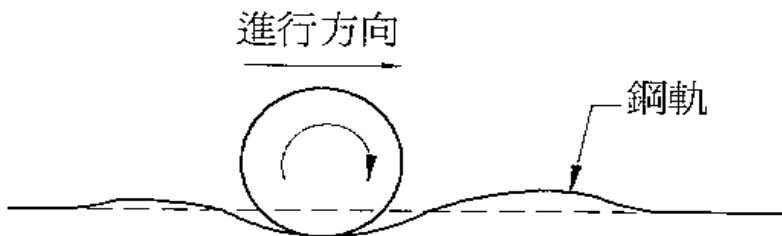
圖 3-15 鋼軌爬行原理
