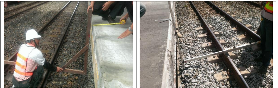
圖 7 臺鐵使用的月台淨空測定尺
