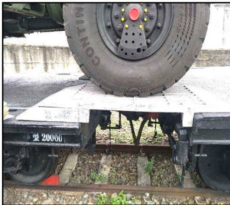
於鋁製橋鈹(組)中心靜態負重 1 小時
