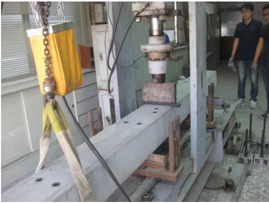
照片 8 PC 枕抗壓測試
