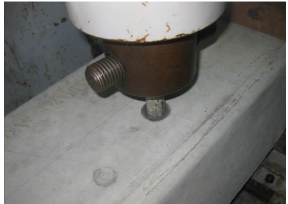
照片 9 PC 枕螺栓孔拉拔測試
