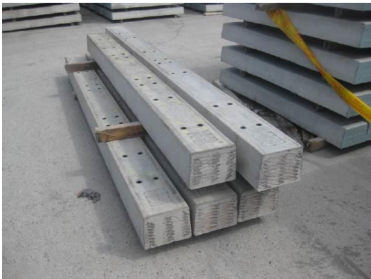
照片 6 PC 枕進行養生流程
