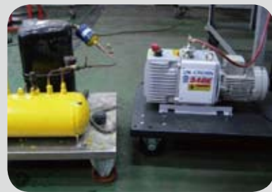
自製真空泵（圖左）與廠商新品（圖右）之外觀比較
