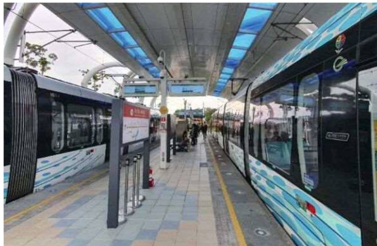
▲淡海輕軌列車為 C 型路權上方高壓電線供電
