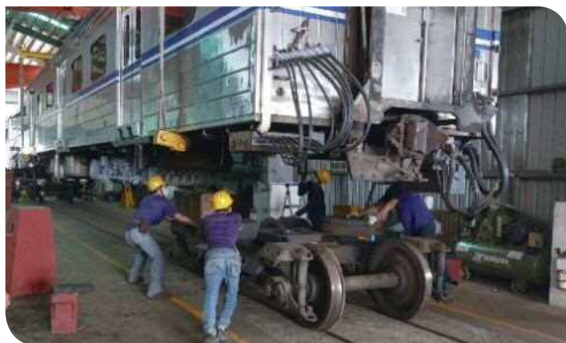
▲轉向架與車架拆解安裝作業
