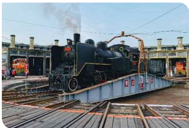
▲扇形車庫蒸汽火車轉盤調頭作業
