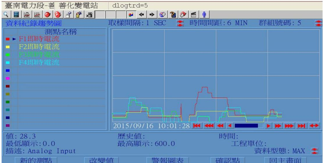
圖 19 新型一對一監控系統之電流趨勢圖畫面
