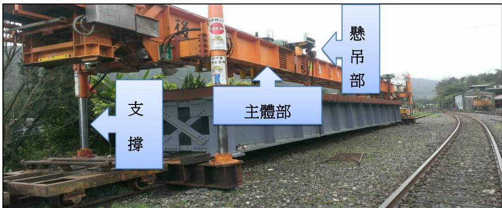
圖 2-1 移動式門型構架吊車各部件說明
