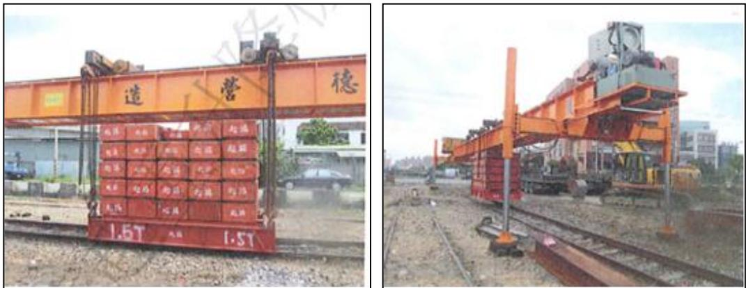
圖 2-2 移動式門型構架吊車試驗情形
