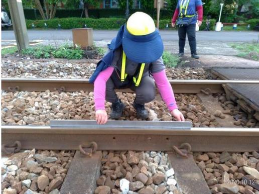
照片 1 以 1m 直尺測量焊道位置軌頭高低差
