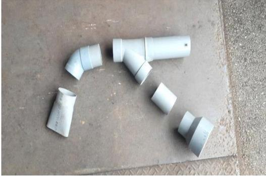
照片 11 利用 2 1/2 英吋 PVC 自製吹管
