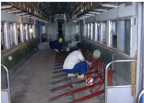
圖 13 TPK32850 兩鐵共乘專車施工 圖 14 兩鐵共乘專車完成全貌
