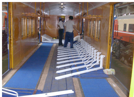
圖 11 輪盤固定架舊料，改裝腳踏車置放架 圖 12 BK32400 改造兩鐵共乘專車施工
