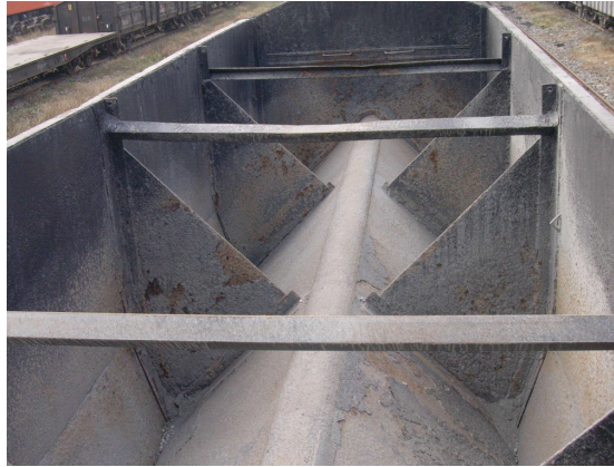
圖 17 35H 煤斗車隔板利用緩動料。
