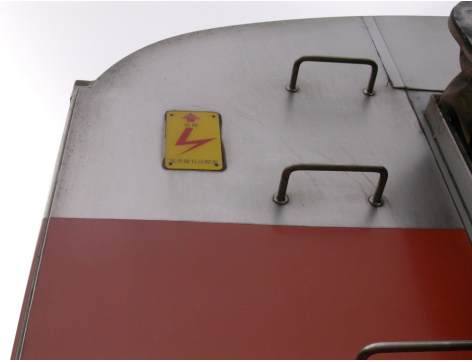
圖 19 高壓電警告牌壓克力製造
