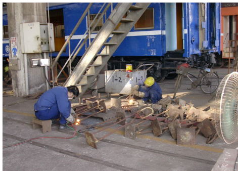
圖 11 輪盤固定架舊料，改裝腳踏車置放架 圖 12 BK32400 改造兩鐵共乘專車施工
