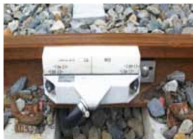
◀ 計軸器雙重化 dual meter shaft
