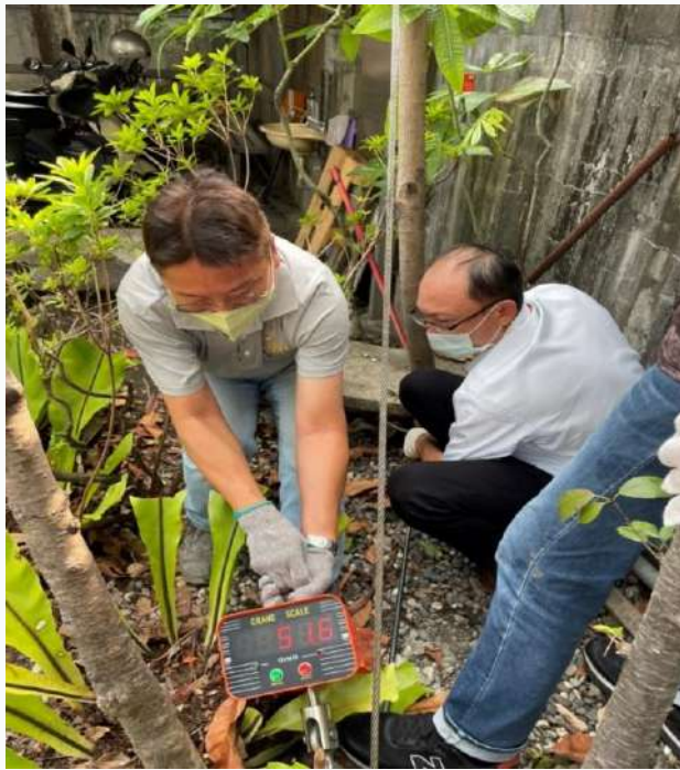
圖 8 原設計影響木拉力彎曲試驗由同向施拉會使 T 型鋼筋翹起，須修正與該鋼筋反向，由助理站在鋼筋上才能方便施作量測拉力不致該鋼筋翹起
