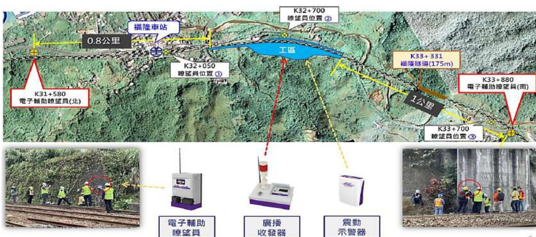
圖 6 電子輔助瞭望員安裝及配置示意圖
