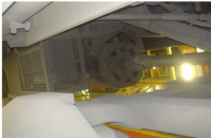
圖 3 牽引動力系統
