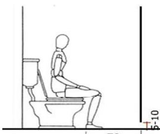
圖 5 坐式便器前緣至前方牆面距離及門縫尺寸
