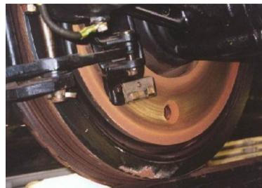
圖 6 碟式煞車
