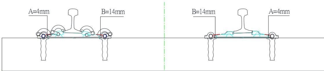
圖 35 加寬 PC 岔枕 20 mm 時之尼龍絕緣座搭配方式
