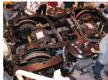
圖 9 轉向架及懸吊系統
