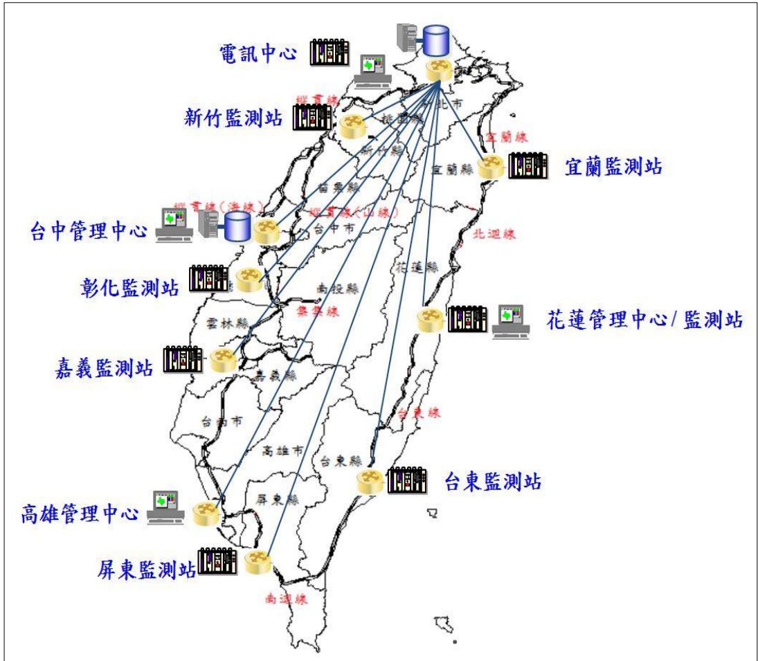
圖 2-2 臺鐵路光纖監測系統站台座落圖
