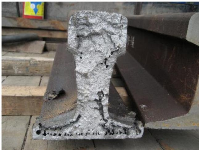
圖 4-43 工務養護總隊 UIC60 鋼軌焊道斷面圖二（預熱不足）
