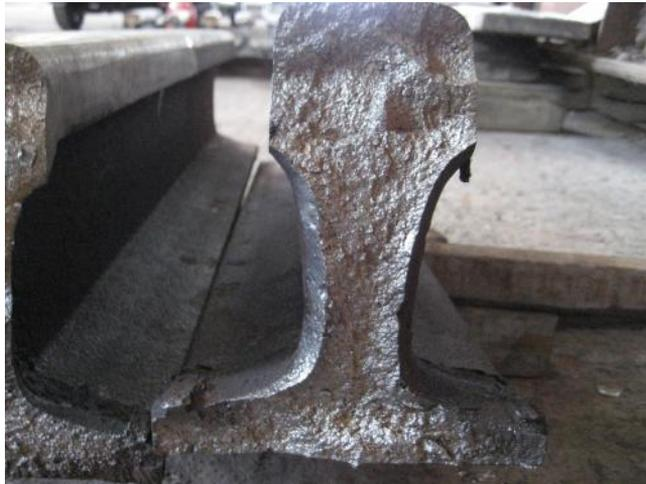
圖 4-46 嘉義工務段 UIC60 鋼軌焊道斷面圖
