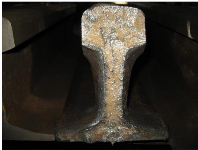
圖 4-49 花蓮工務段 UIC60 鋼軌焊道斷面圖
