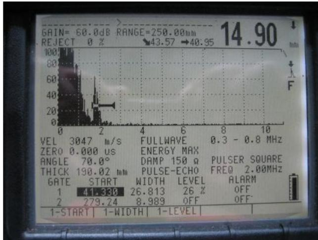
圖 5-10 70°探頭對鋼軌（預熱不足）軌腹焊道的檢測波形數值圖三
