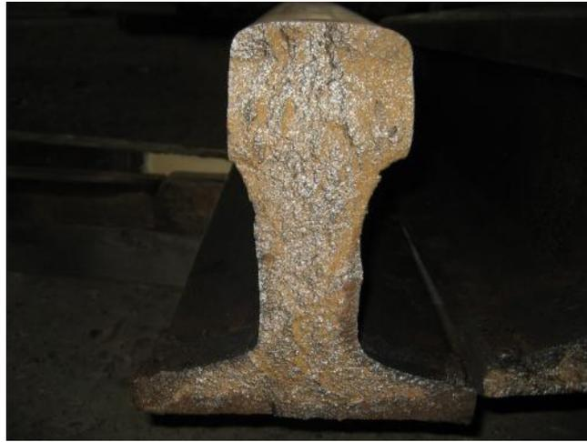
4-48 宜蘭工務段 UIC60 鋼軌焊道斷面圖
