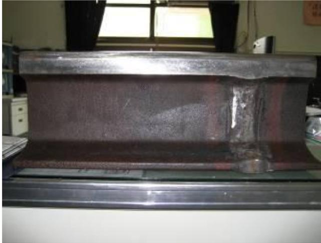
圖 4-3 人工缺陷規塊成品圖
