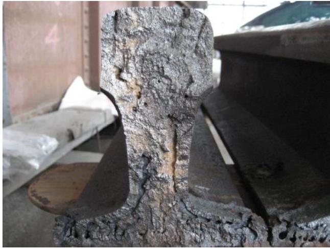
圖 4-42 工務養護總隊 UIC60 鋼軌焊道斷面圖一（預熱不足）
