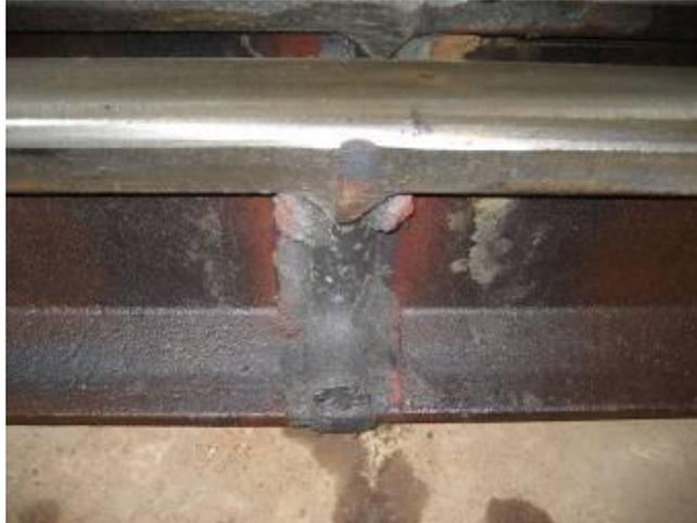
圖 4-9 UIC60 鋼軌鋁熱劑焊道圖 (預熱不足)
