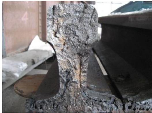
圖 5-1 UIC60 鋼軌焊道（預熱不足）焊道斷面圖
