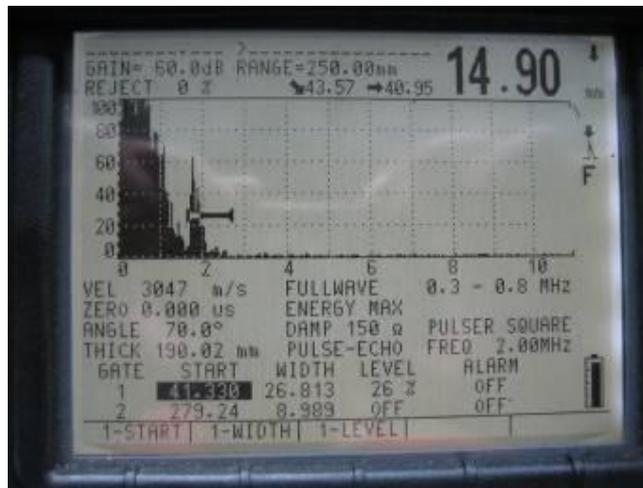
圖 4-15 70° (斜束) 探頭對軌頭焊道(預熱不足)檢測示意圖三
