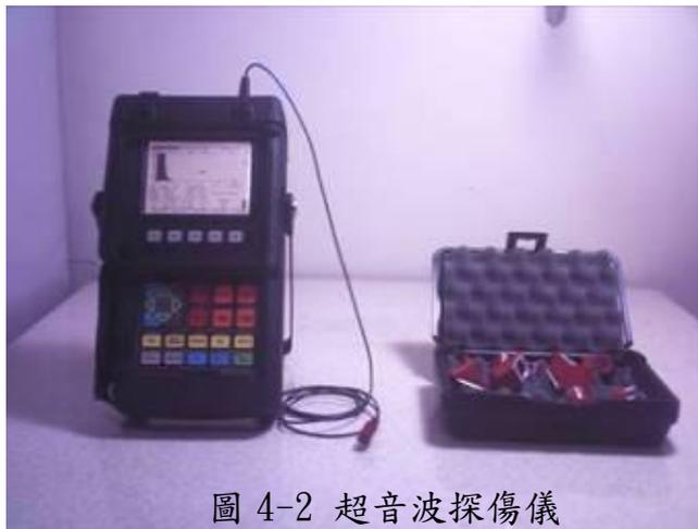
圖 4-2 超音波探傷儀
