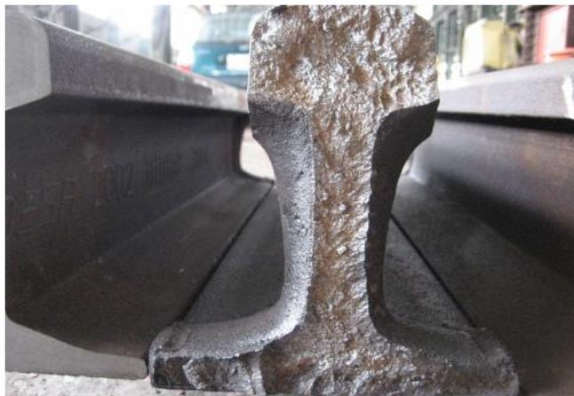
圖 4-44 台北工務段 UIC60 鋼軌焊道斷面圖
