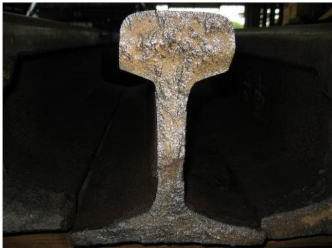
圖 4-47 高雄工務段 UIC60 鋼軌焊道斷面圖
