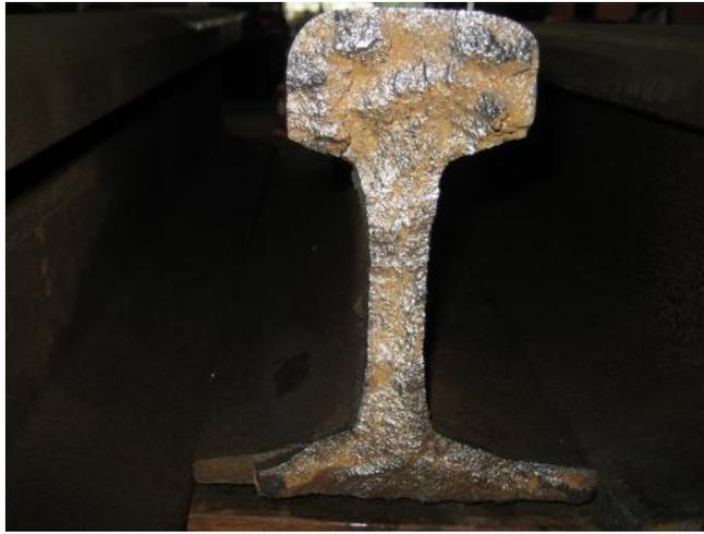
圖 4-45 台中工務段 UIC60 鋼軌焊道斷面圖
