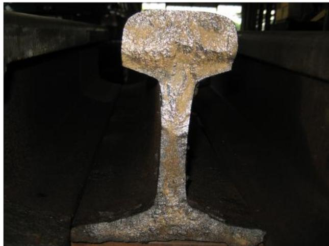
圖 4-50 台東工務段 UIC60 鋼軌焊道斷面圖
