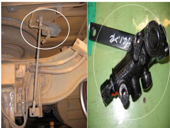
圖 2-5 臺北捷運 301 型水平閥
