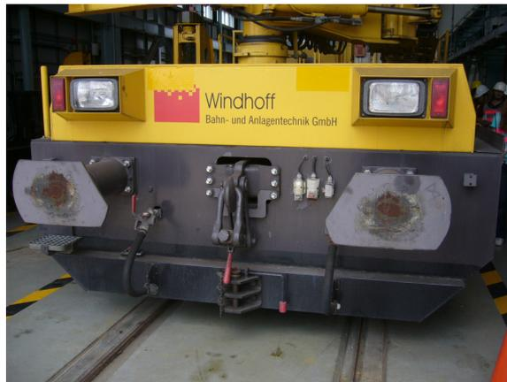
圖 6：螺旋聯環式連結器及緩衝器安裝實例（臺灣高鐵工程車）
