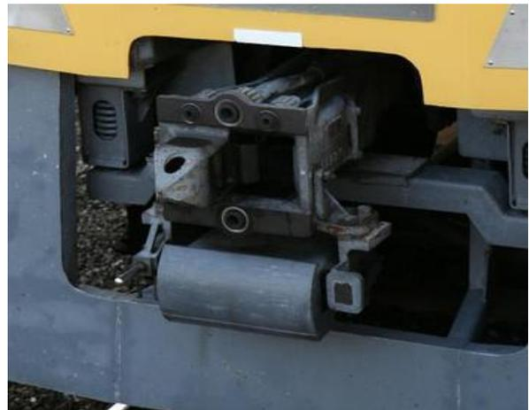
圖 17: 密著自動連結器安裝實例<sup>【3-9】</sup>
