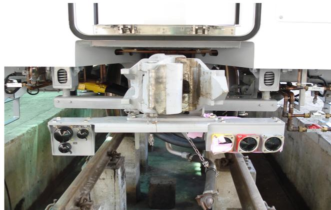
圖 28：太魯閣號列車連結轉接器安裝示意圖
