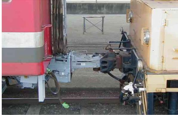
圖 26：不同連結器安裝轉接器之連結示意圖【3-9】
