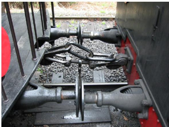
圖 5：螺旋聯環式連結器及緩衝器安裝實例【3-9】
