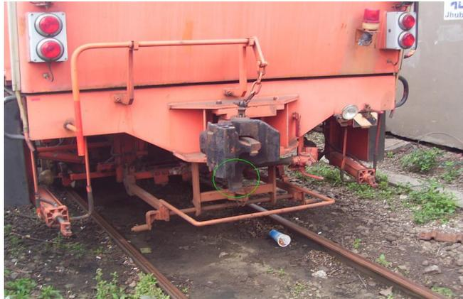
圖 46：裝配 Type SBE 自動連結器的（竹北車站）臺鐵工程車【3-9】
