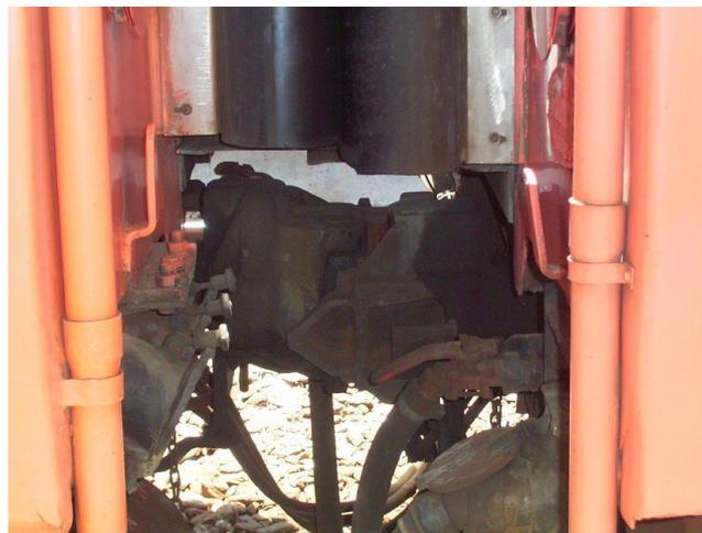
圖 44：配置不同形式連結器之車廂連結狀態【3-9】
