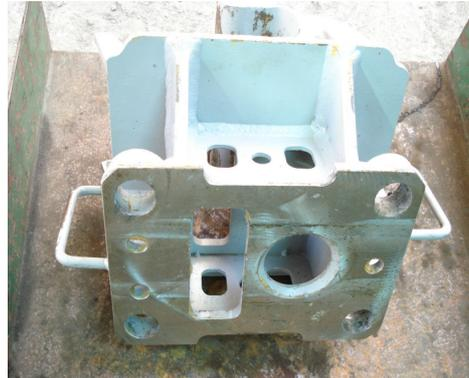
圖 27：臺鐵太魯閣號列車連結轉接器
