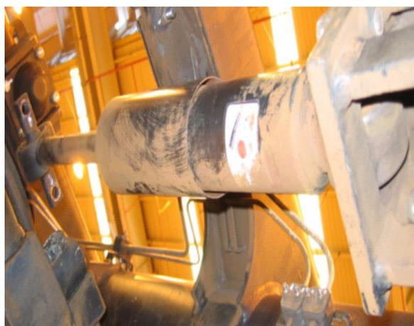
圖 2-8 臺北捷運 321 型橫向阻尼器
