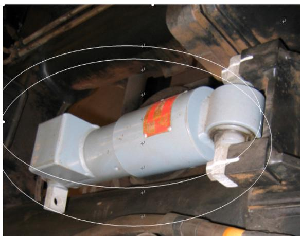
圖 2-7 臺北捷運 301 型橫向阻尼器
