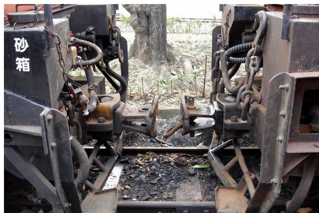
圖 2：插銷連環式連結器安裝實例【3-9】
