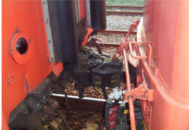
圖 43：配備 AAR Type E 型連結器之臺鐵 E200 電車機車頭與配備 AAR Type H 型連結器之莒光號車廂連接狀態【3-9】
