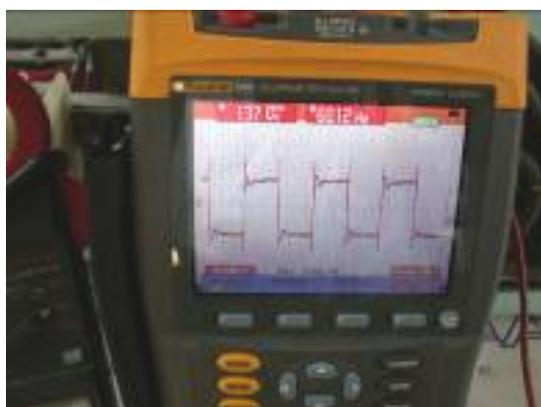
（圖 9）傳統 1.5K 變流器配電子安定器之波型
