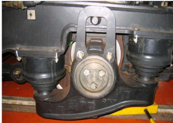
圖 5-3 臺北捷運 321 型主懸吊系統
