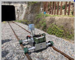
隧道及邊坡改善統包工程隧道淨空測量
