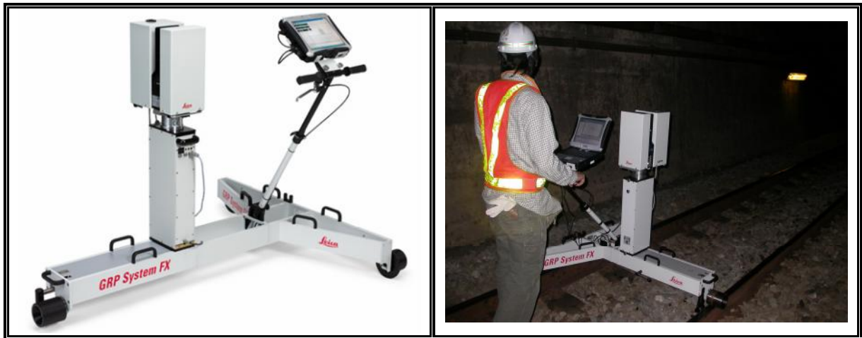
圖 3.5-1 GRP5000 隧道影像掃描系統 圖 3.5-2 隧道影像掃描現場作業照片
