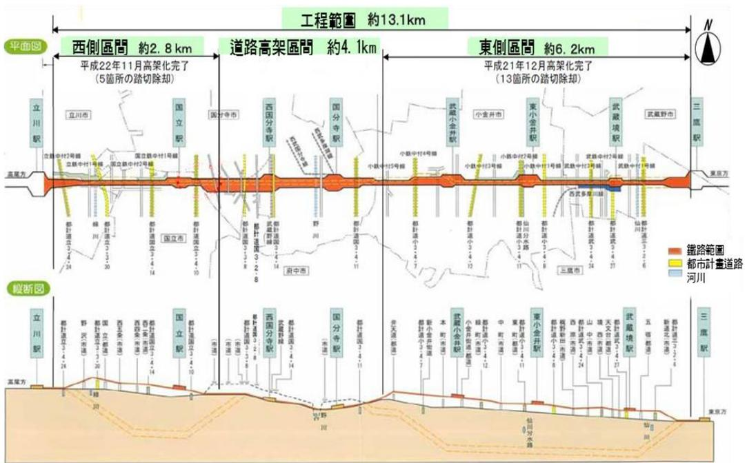
圖 6 日本 JR 東日本中央線連續橫交路段立體化工程示意圖
