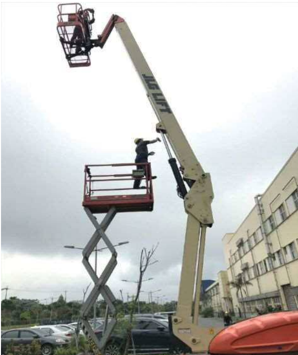
▲ 高空作業車定期保養作業
