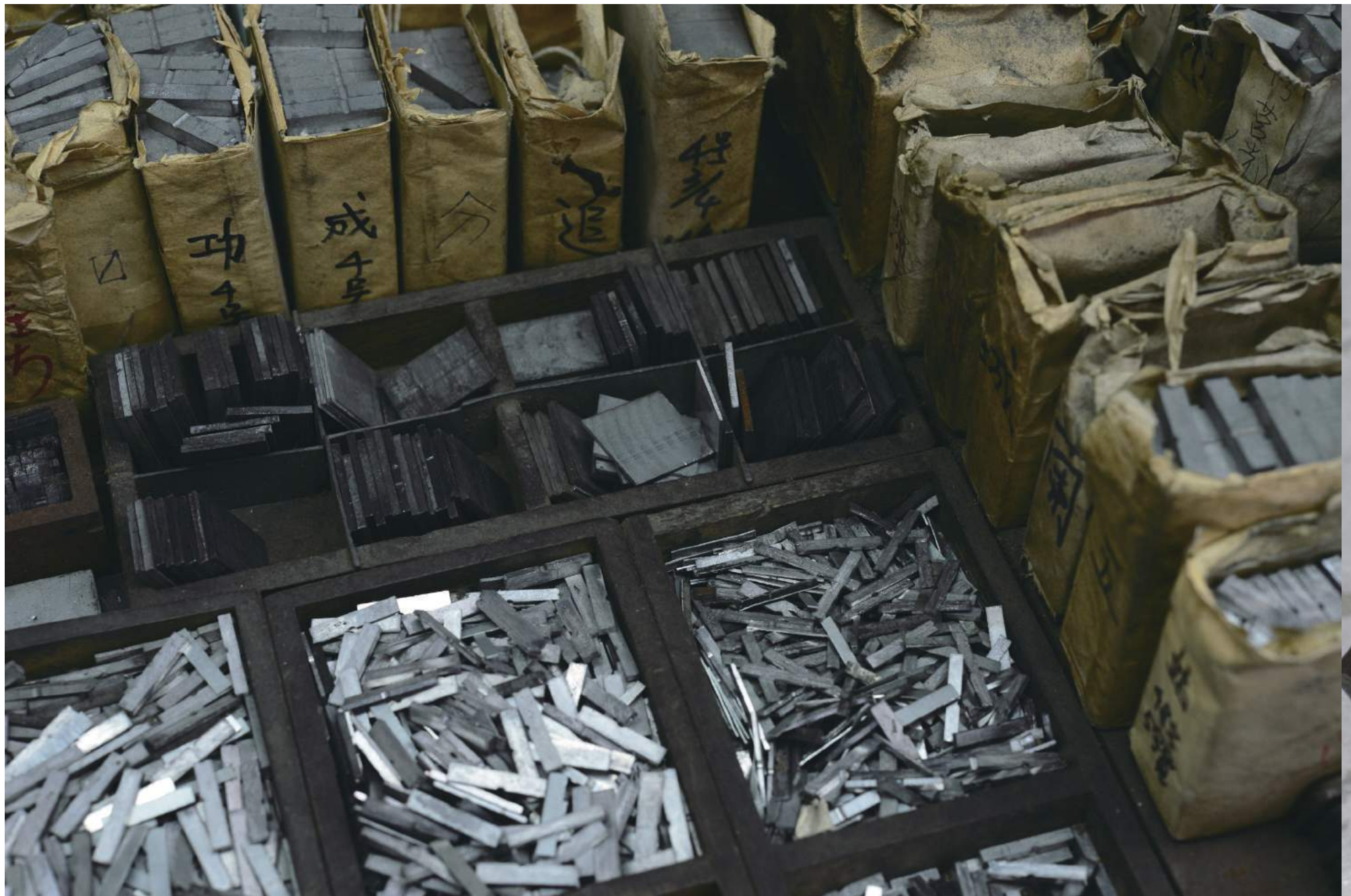
用於排版材料，包含鉛字與空鉛 Types and blanks for typesetting.
