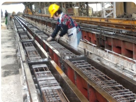
| 8. PC 枕生產線 PC 枕內需依圖面指示加入鋼筋及預力鋼絞線。
