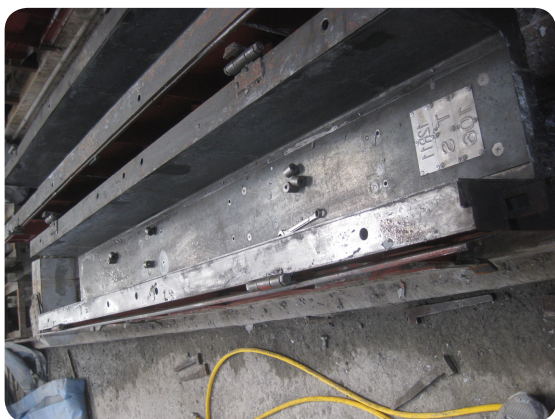
| 7. PC 枕模具 每支 PC 枕孔位皆不同，需確認所有孔位正確。
