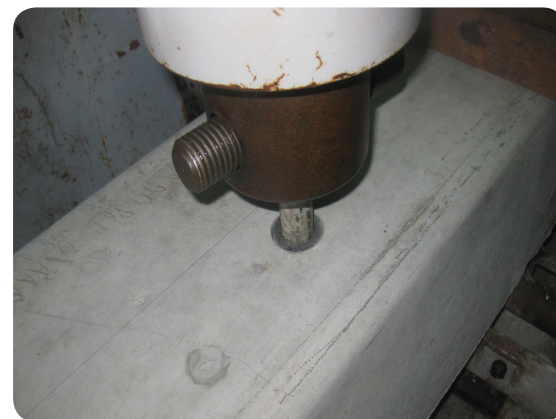
| 12. PC 枕螺栓孔拉拔測試 此測試可確保 PC 枕螺栓孔強度。
