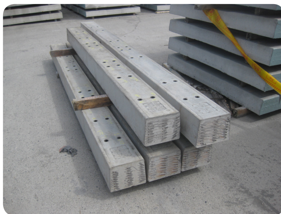
| 9. PC 枕成品 PC 枕成品製作完成後，需要依規範指示完成養生流程，PC 枕才能達到設計強度。
