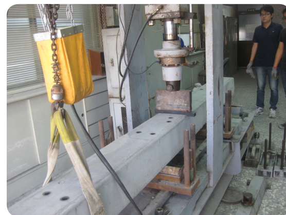
| 11. PC 枕抗壓測試 PC 枕製作完成後應依規範進行抗壓測試，確保使用上安全無虞。
