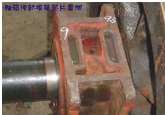
軸箱頂部填隙墊片量測
