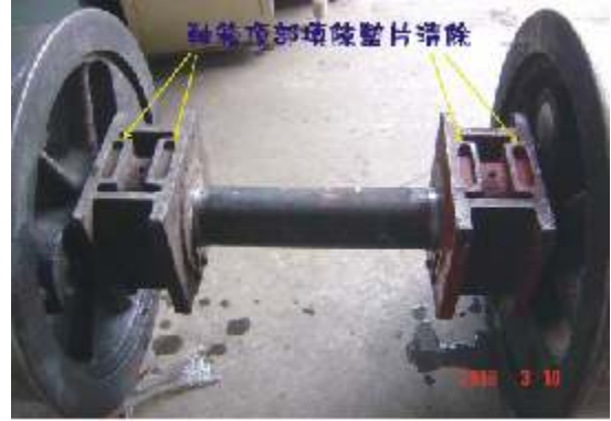
軸箱頂部填隙墊片清除
