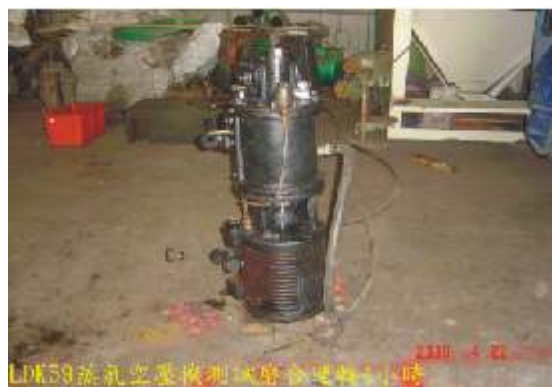
LDK59蒸氣空壓機測試磨合運轉4小時
