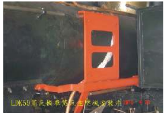
LDK59蒸氣機車蒸氣空氣壓縮機安裝座
