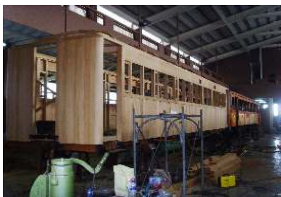
LTPS1102整修作業中。
