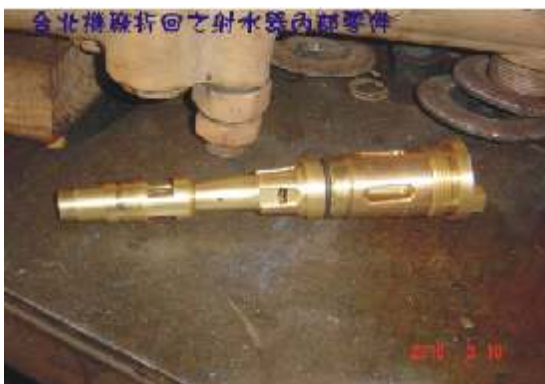
臺北機廠拆回之射水器內部零件
