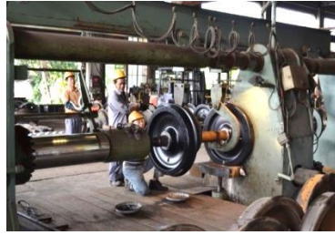
圖 2-2 軸引器導引組裝
