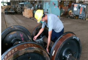
圖 2-3 量測規三點量測
