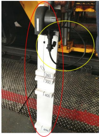
紅圈: 砸道深度調校板 黃圈: 延長線接座
