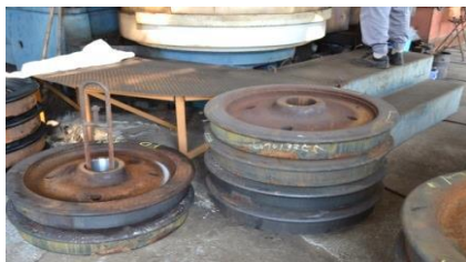
圖 3-13 緩動料車輪 PD-660301 (B) 硬度值 HB250-291
