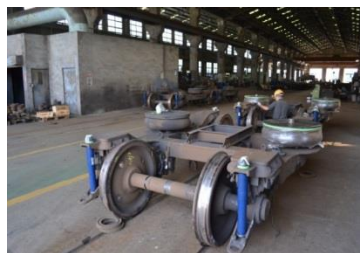
圖 3-22 更新後油壓避震器
