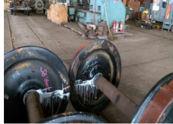
圖 2-4 量測規三點量測完成
