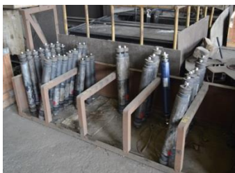
圖 3-21 更新前油壓避震器
