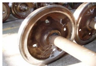
圖 3-6 車輪組裝完成(2)
