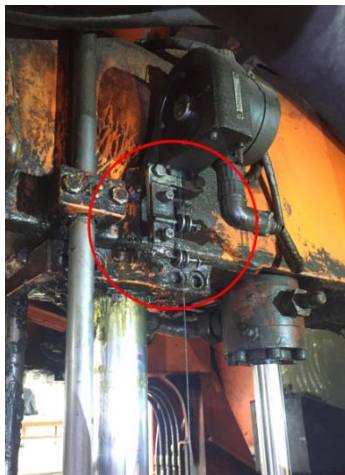
紅圈: 深度電位計導輪
