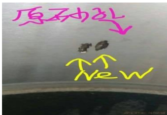
圖 3-10 軸孔處有砂孔狀
