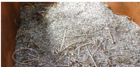
圖 3-11 平面車輪車床銼削鐵屑外觀
