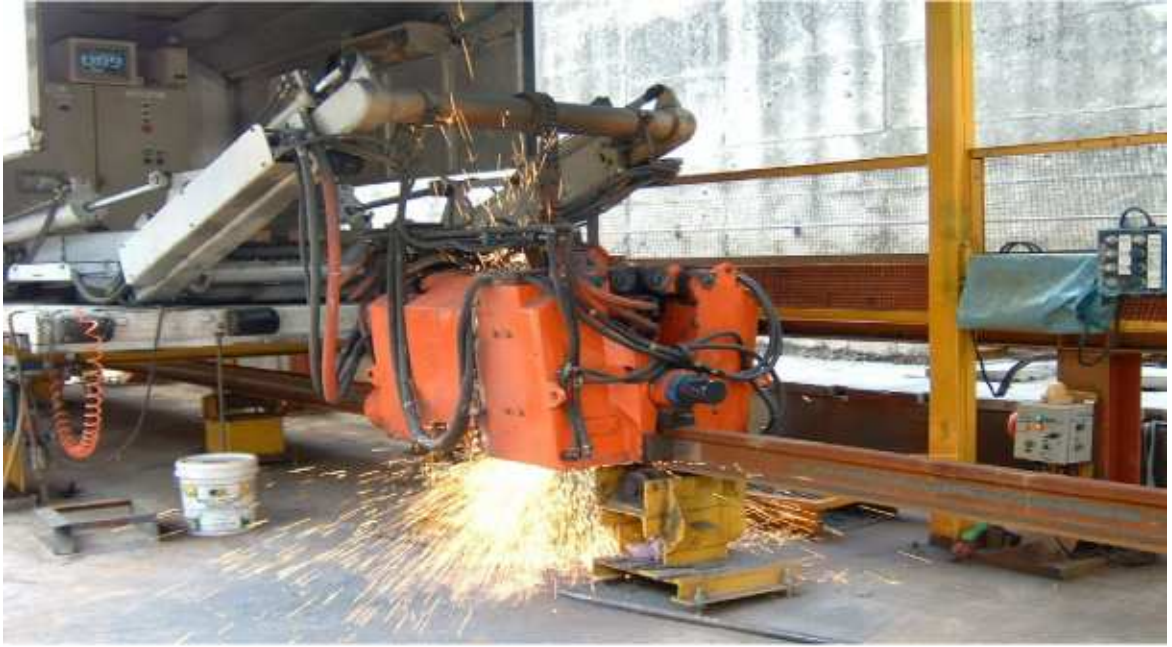
圖 4-2b 電阻火花焊接作業
