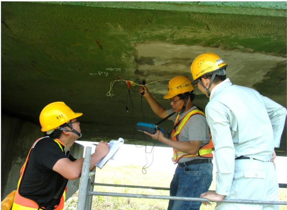
圖 24 自然電位法每隔半年量測一次，可得知鋼筋腐蝕現象是否抑止
