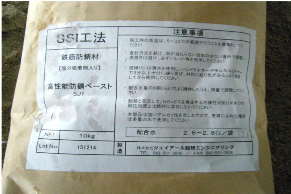
圖 20 鋼筋腐蝕抑制劑(型號 SJ1)
