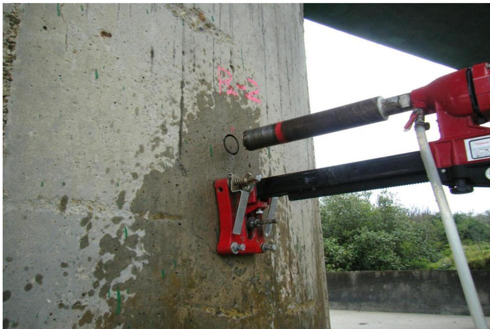
圖 15 SSI 工法施作前鑽芯，以確認混凝土中性化及氯離子含量
